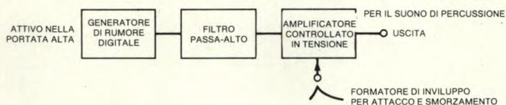
Figura 1c. Schema a blocchi per creare il rumore di percussione.
