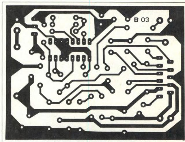
Figura 10. Disposizione dei componenti sulla basetta della sirena parlante.
