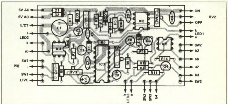
Figura 7. Disposizione dei componenti sulla bassetta del dispositivo di controllo.
