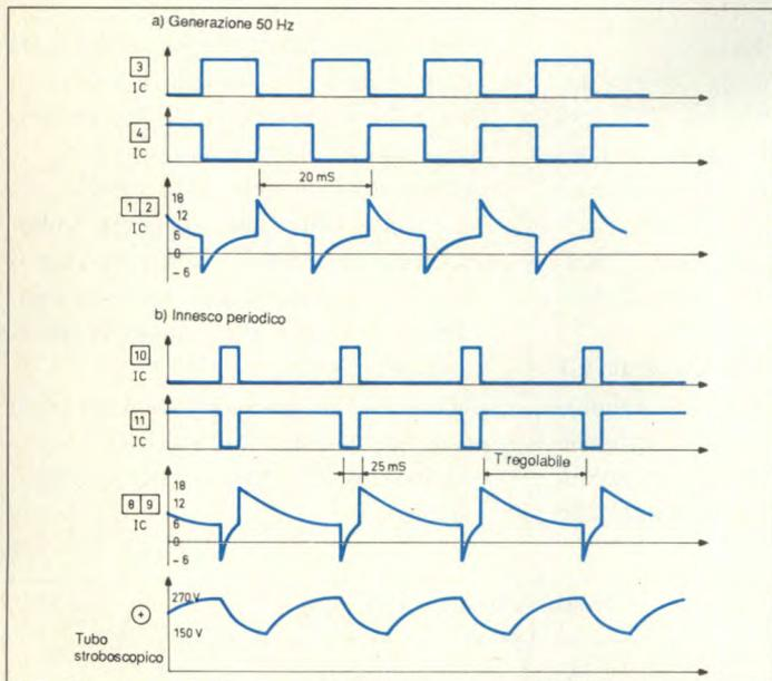
Figura 4. Oscillogrammi di funzionamento del circuito del flash per auto. a) Generazione della frequenza di 50 Hz. b) Innesco periodico.
