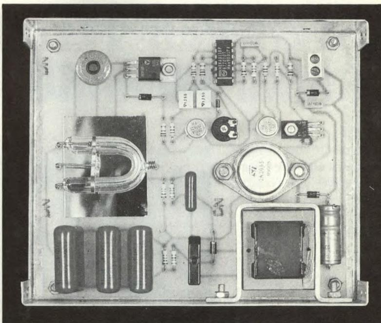
Non è necessario un dissipatore termico per il transistor T3. E' invece opportuno raffreddare il trasformatore montando un radiatore a staffa in alluminio. Il transistor subisce in realtà un riscaldamento superiore al normale perché le tensioni elaborate non hanno la forma d'onda perfettamente sinusoidale. Conviene anche individuare esattamente, con una semplice misura della loro resistenza ohmica, gli avvolgimenti primario e secondario dell'induttore di in-
