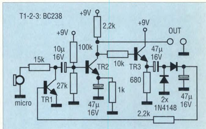
Figura 2. Schema elettrico del preamplificatore microfonico con controllo automatico di guadagno. TR1 è un attenuatore attivo.
