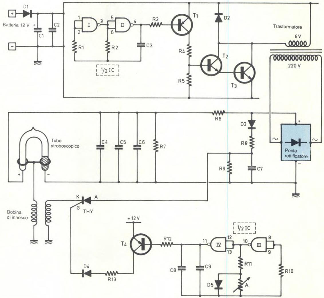
in modo che il multivibratore fornisca onde rettangolari con rapporto impulso/pausa del 50% e periodo di 20 ms: vale a dire, una frequenza di 50 Hz. Queste onde rettangolari subiscono un'amplificazione di corrente da parte del transistor T1, il cui collettore alimenta poi, tramite il resistore limitatore R4, la base del transistor di media potenza T2, accoppiato al transistor di potenza T3 in modo da formare un circuito Darlington. Il secondario del trasformatore ri-
