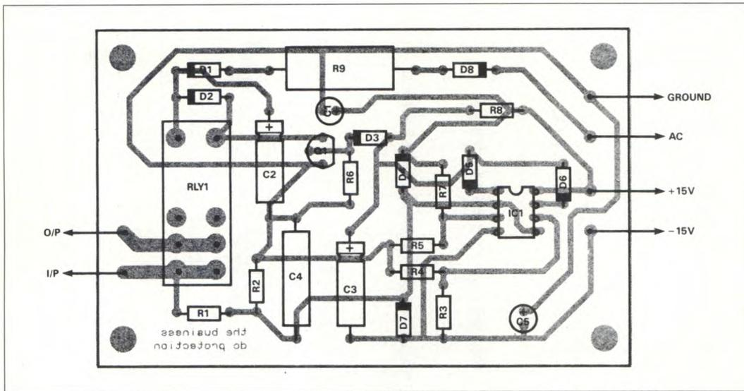
Figura 10. Componenti del circuito di protezione c.c. ed anti-thump.
