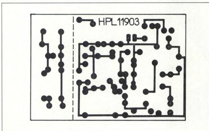
Figura 3. Disposizione dei componenti sulla basetta stampata del trasmettitore. Il circuito di misura visibile sulla parte destra, va separato e collegato ad un oscilloscopio o ad un dip-meter.
