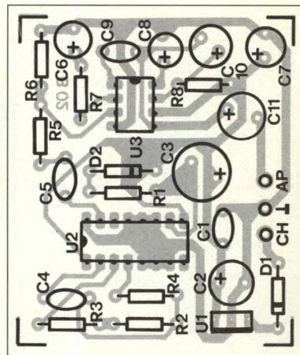
Figura 7. Disposizione dei componenti sulla basetta stampata dell'avvisatore per cinture di sicurezza. Montare l'MSM su zoccolo e rispettare il verso di inserzione dei componenti polarizzati.
