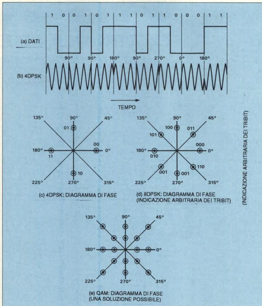
Figura 3. Tecniche avanzate di modulazione dei dati.
