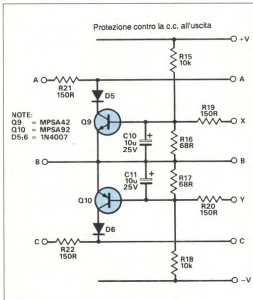
Figura 11. Schema elettrico della protezione contro il cortocircuito.
