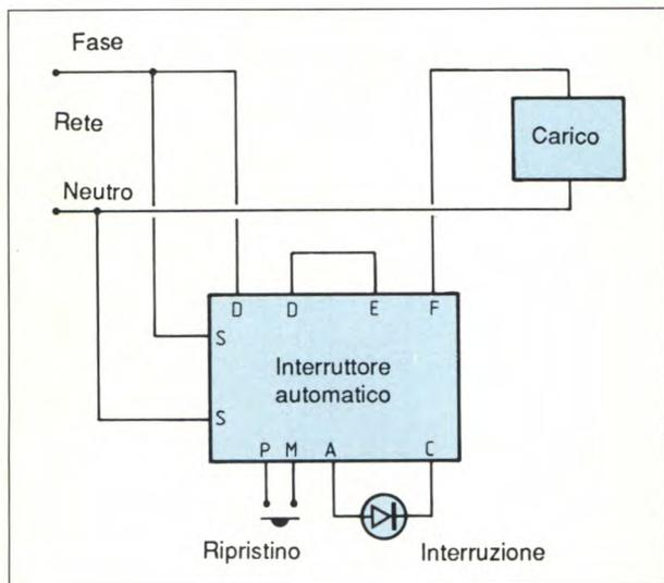
**Figura 7. Installazione dell'interruttore automatico in un impianto elettrico.**
