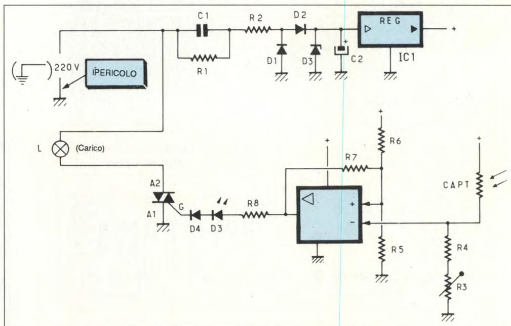
Figura 1. Schema elettrico: l'ampli operativo confronta la tensione di riferimento con l'informazione proveniente dal fotoresistore.
