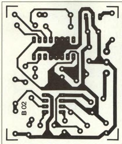
Figura 6. Circuito stampato del circuito avvisatore per cinture di sicurezza, visto dal lato rame in scala unitaria. Le sue piccole dimensioni ne permettono l'installazione all'interno del cruscotto dell'auto.
