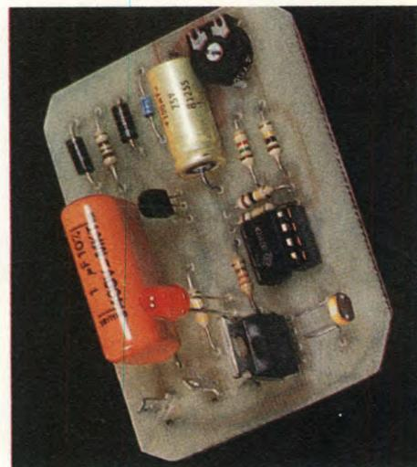
garantiscono una rettificazione a singola semionda, mentre il diodo Zener D3 limita a 20 V la tensione ai capi di C2. Di conseguenza, ai capi di C2 si ottiene una tensione filtrata, quasi continua e prossima a 20 V. Poiché questa tensione varia con la corrente assorbita dal circuito,
