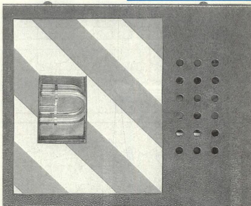
ottenuti vengono poi rettificati e filtrati mediante un condensatore di sufficiente capacità. Una base dei tempi fornisce un impulso periodico di comando che, dopo una sufficiente amplificazione, fa partire la scarica del tubo stroboscopico. Ne risulta un breve lampo luminoso, relativamente intenso e quindi ben visibile. Si può inoltre regolare la frequenza dei lampi al valore desiderato.
