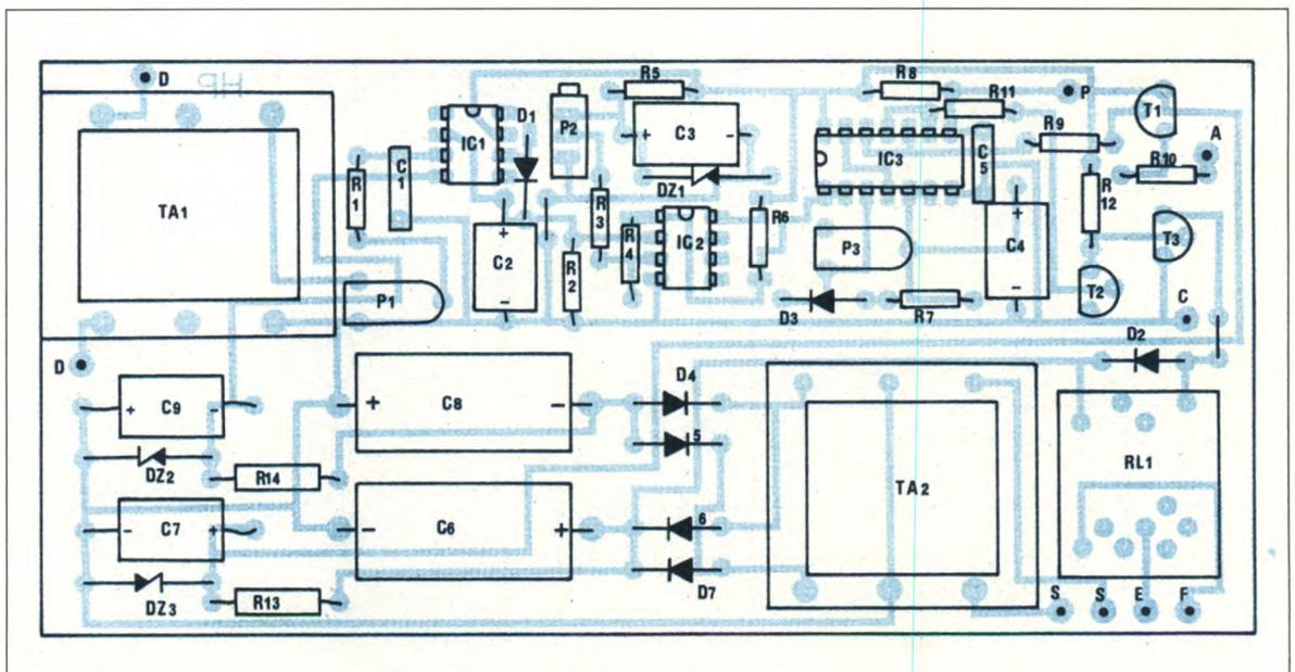
Figura 5. Disposizione dei componenti sulla basetta.
