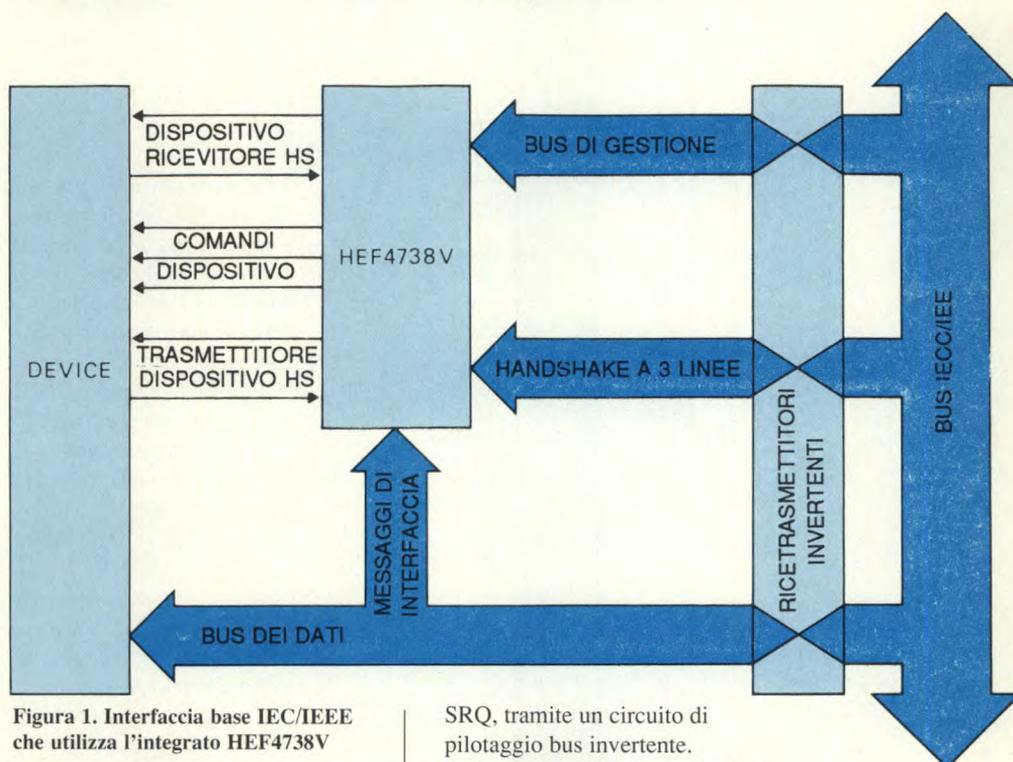
Figura 1. Interfaccia base IEC/IEEE che utilizza l'integrato HEF4738V
