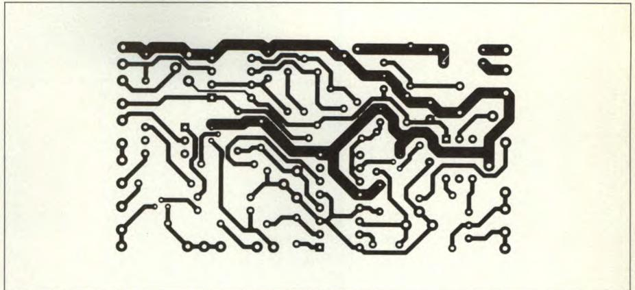
Figura 6. Circuito stampato della bassetta di controllo visto dal lato rame in scala 1:1.
