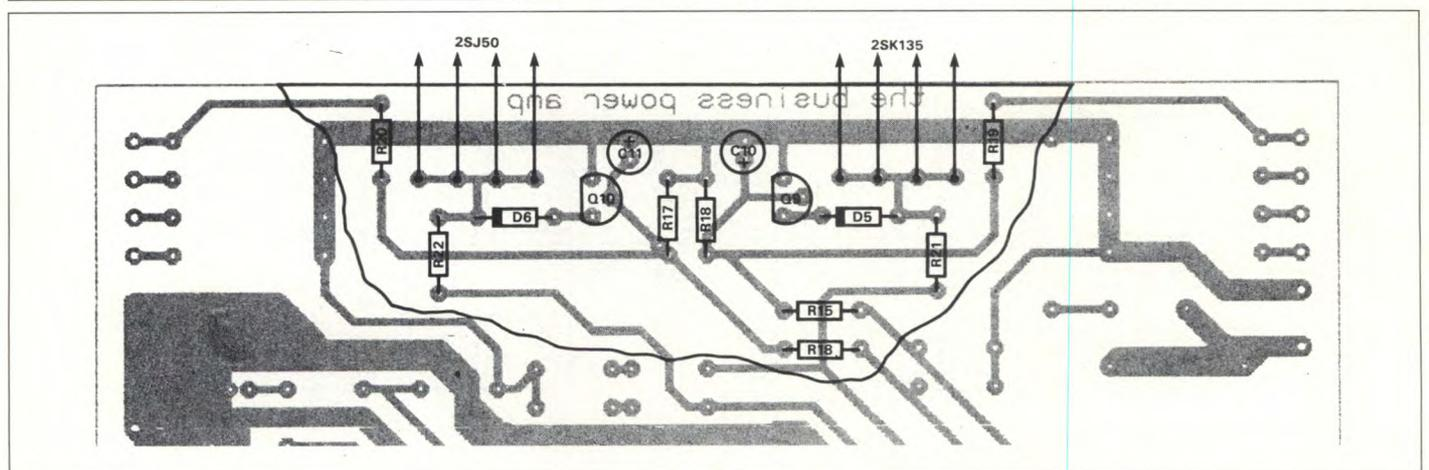
**Figura 13. Schema dei circuiti di rilevamento livello d'uscita e controllo volume.**
