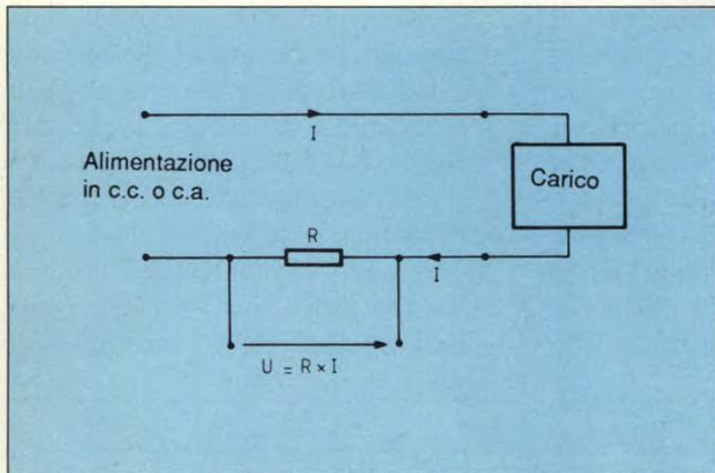
Figura 1. Sistema classico per la misura della corrente.
