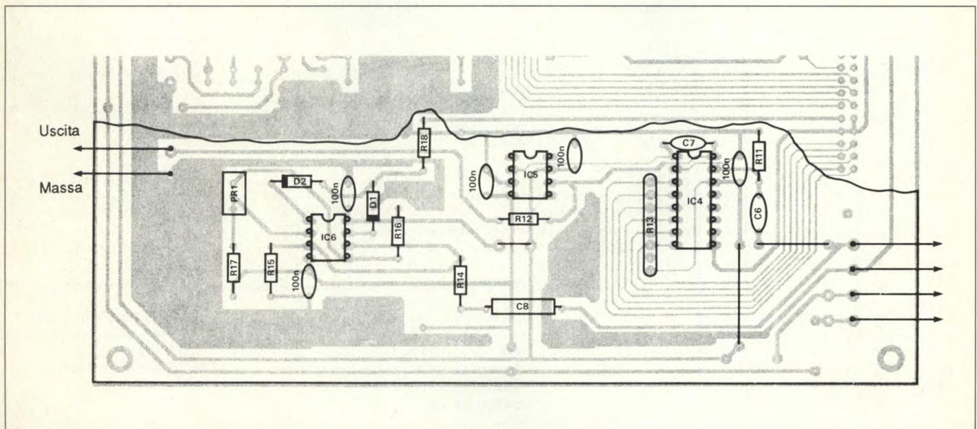
dell'amplificatore. Il circuito di sovraccarico è un comparatore a finestra, con rivelatore di picco e soglia regolabile. Predisporre quest'ultima in modo da indicare il sovraccarico, con il LED sul pannello frontale, quando è pilotata da un'onda sinusoidale da 1 kHz/10 Veff. Durante l'utilizzo, aggiustare la regolazione grafica di ciascun canale e predi-
