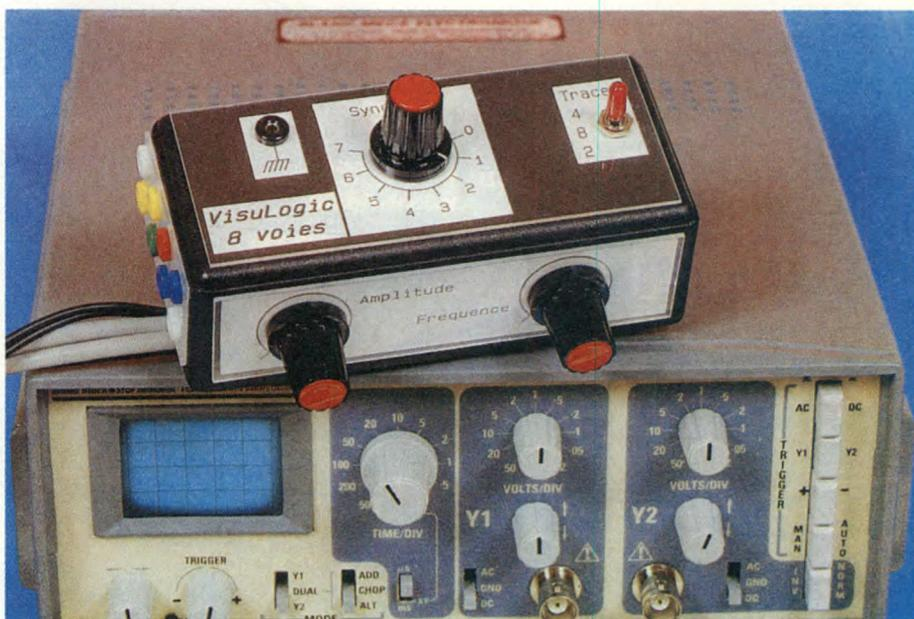
voler analizzare soltanto segnali logici permette un'estrema semplificazione del circuito, come vedremo in seguito. Il segnale complesso inviato all'oscilloscopio è del tutto inadatto alla sua sincronizzazione. E' quindi previsto un collegamento diretto tra i circuiti di sincronismo dell'oscilloscopio ed uno dei canali (scelto con un commutatore) a monte del multiplexer. L'oscilloscopio utilizzato dovrà pertanto essere munito di una presa di sincronismo esterno, cosa comune del tutto normale.
