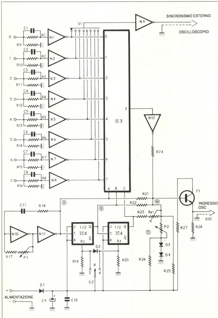
Figura 2. Schema elettrico del Visulogic.
