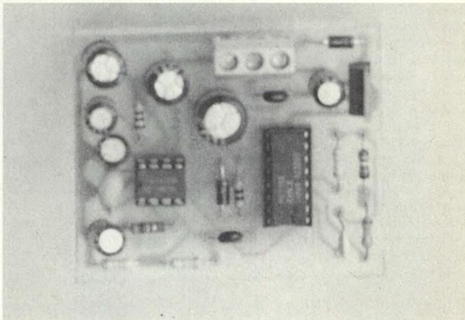
femminile: "Nell'augurarvi buon viaggio, vi preghiamo di allacciare le cinture". Il montaggio all'interno della vettura è molto semplice. L'alimentazione andrà connessa col positivo sotto chiave che potrà essere prelevato in differenti punti della vettura. Occultate il circuito e l'altoparlante dietro il cruscotto o nella posizione che riterrete più idonea. Passiamo ora ad analizzare il funzionamento del secondo circuito, ovvero la sirena parlante.
