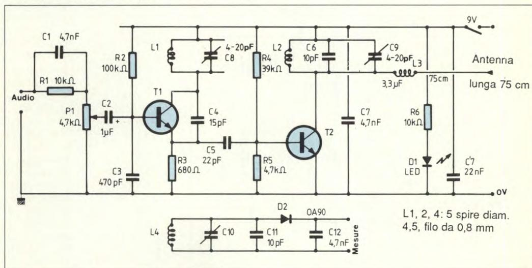
dell'antenna, l'accordo non subirà praticamente variazioni. C9 verrà regolato per il massimo livello d'uscita. Sotto allo schema elettrico è disegnata l'interfaccia, formata da un circuito accordato da C10, in parallelo a C11: la banda passante si estende, da una parte e dall'altra, al di fuori della banda FM. Il segnale viene rivelato dal diodo
