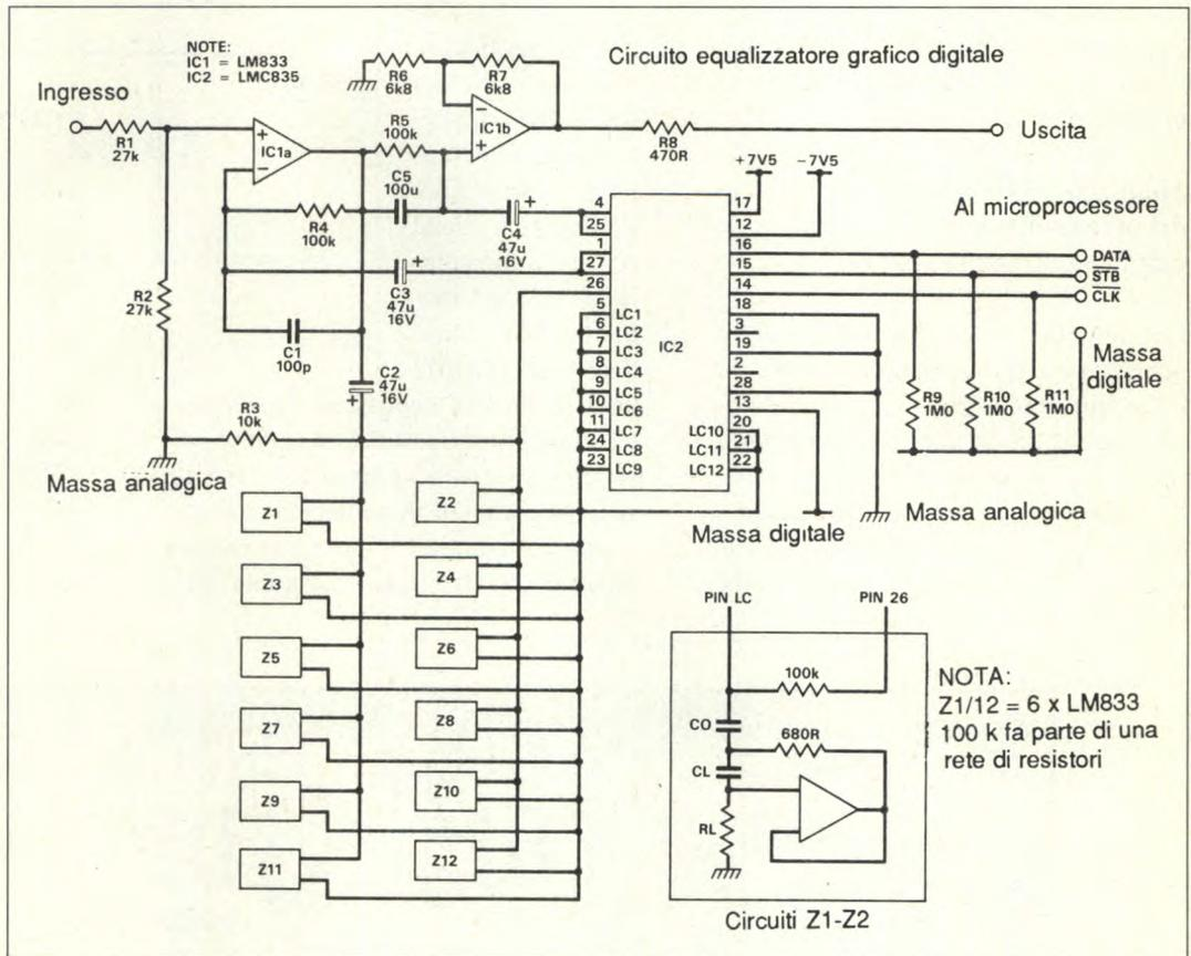
al livello desiderato della banda selezionata in precedenza. In Tabella 2 è illustrato un diagramma di temporizzazione. Da notare che il bit D0 viene introdotto per primo ed il bit D7 per ultimo. La tabella mostra la codifica usata per la selezione della banda e del guadagno. Con la frequenza di clock di 500 kHz, l'intero equalizzatore può essere programmato in meno di 500  $\mu$ s.
