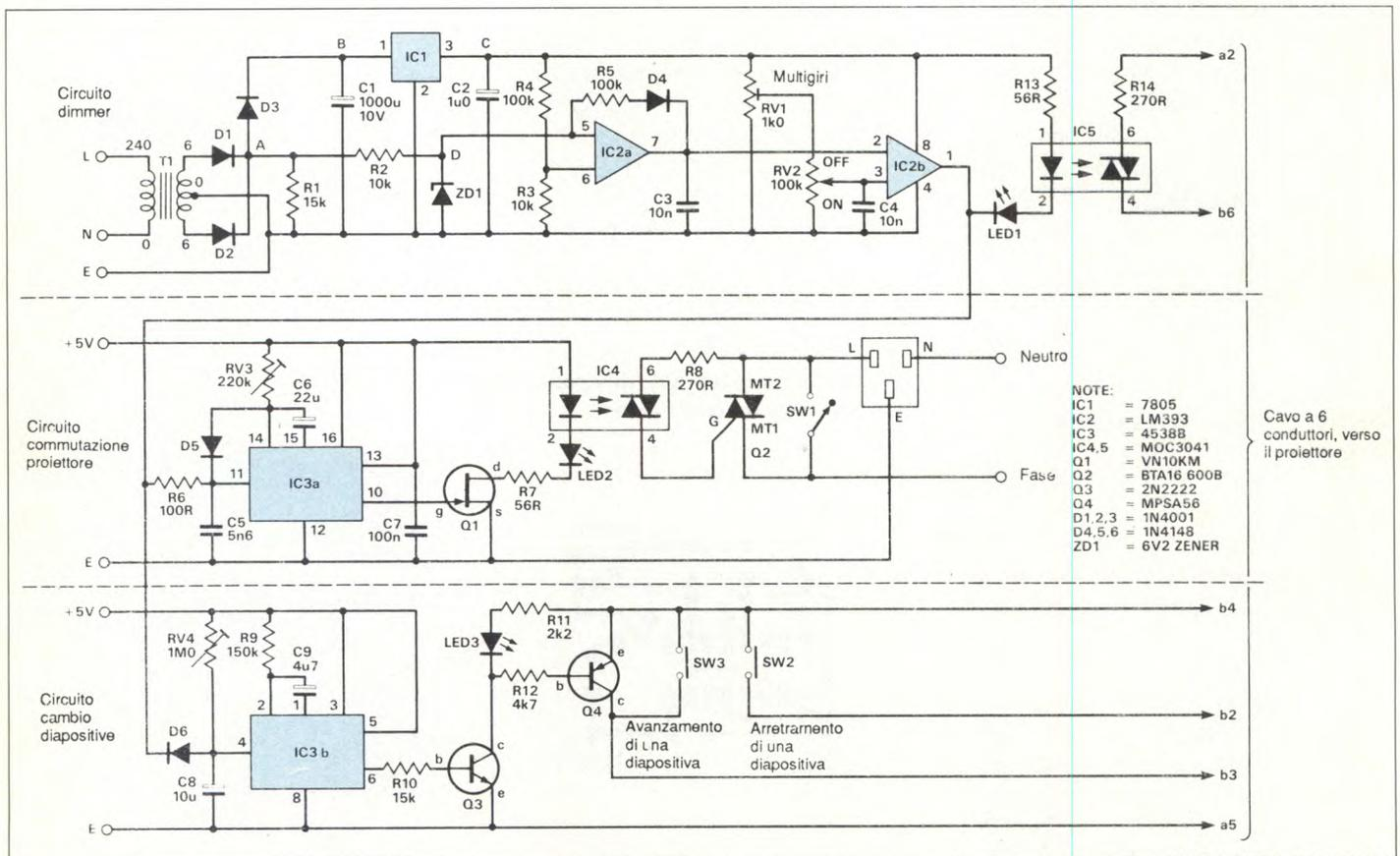
costruito senza troppa spesa, utilizzando componenti di facile reperibilità. Per soddisfare ad alcuni di questi requisiti, il circuito è stato sviluppato intorno al doppio comparatore di tensione integrato LM393, progettato per funzionare con un'unica linea di alimentazione. In conclusione, abbiamo messo a punto il circuito dimmer, illustrato in Figura 1.
