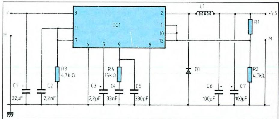
dei 15 piedini), contiene tutti gli elementi necessari, compresi gli stadi di potenza. Per questo motivo è dotato di una protezione termica contro i surriscaldamenti. I diversi gruppi RC intorno al chip determinano le condizioni di funzionamento dell'oscillatore interno. La tensione d'uscita viene predisposta agendo su R1, in base alla seguente formula:
