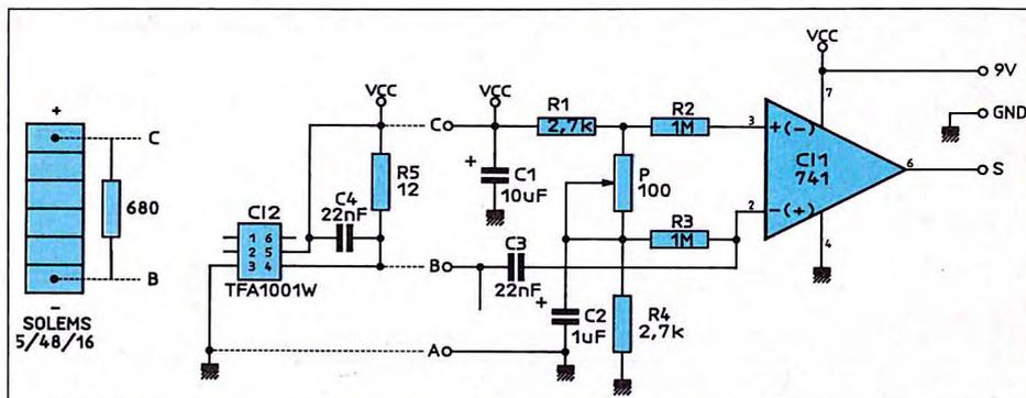
Figura 5. Circuito elettrico del ricevitore.
