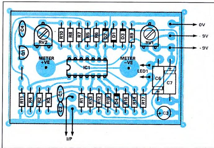
Figura 6 . Disposizione dei componenti sulla bassetta stampata.
