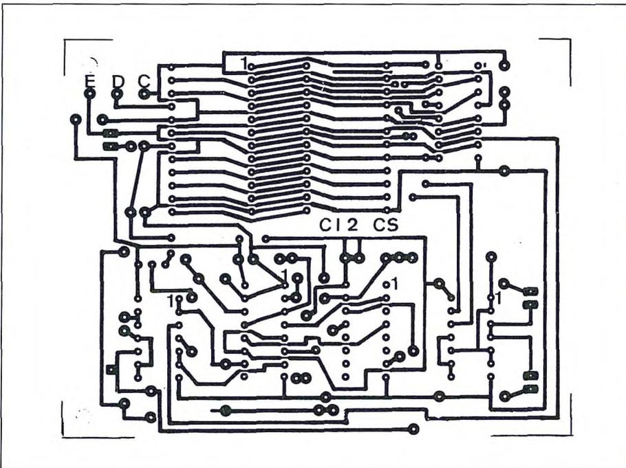
**Figura 9. Piste di rame del circuito stampato del duplicatore viste in scala naturale. Attenzione alle linee ravvicinate.**
