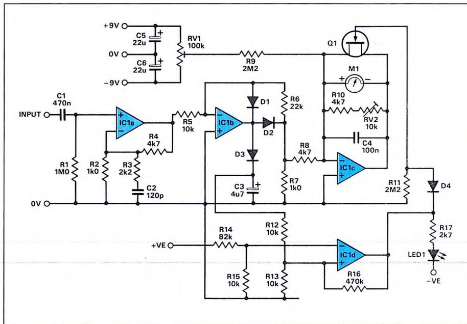
Figura 4. Schema elettrico del millivoltmetro analogico in c.a.
