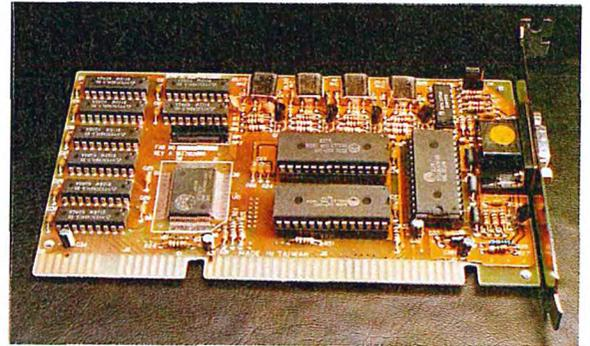
Passando allo standard VGA, una buona scheda con memoria autonoma, set di quarzi e chip convertitore digitale/analogico permette il collegamento di qualsiasi monitor anche professionale, avendo come connettore d'uscita un 15 poli PS/2 compatibile.
