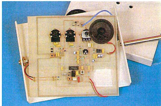
lato per un'induttanza di 740 nH (a mezza corsa del nucleo), la capacità totale per realizzare la sintonia è di 44 pF, ottenuta quando il cursore di R19 fornisce un potenziale di 2,5 V su D1 e D2, più il condensatore di 15 pF in parallelo. Gli anodi sono collegati a massa tramite l'avvolgimento del secondario L3. La sintonia è molto stretta a motivo dell'elevato valo-
