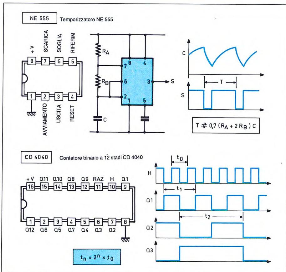
**Figura 4. Piedinature e funzionamento dei circuiti integrati.**
