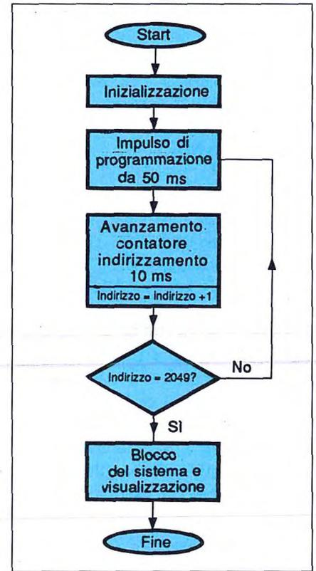
Figura 3. Diagramma di flusso funzionale del duplicatore.
