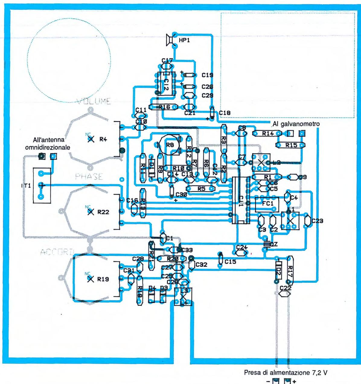
Figura 6. Disposizione dei componenti sulla basetta.
