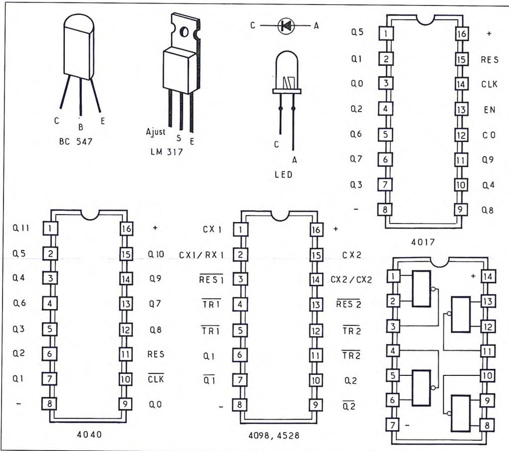
Figura 12. Piedinatura dei componenti impiegati nel progetto.
