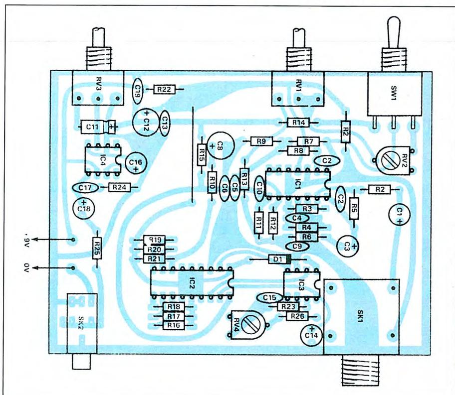
impossibile senza gli spinotti. Inserire e saldare tutti i componenti passivi e l'unico ponticello.
