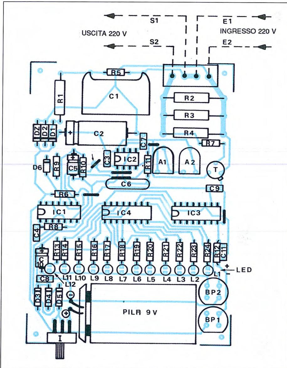
Figura 6. Disposizione dei componenti sul circuito stampato.
