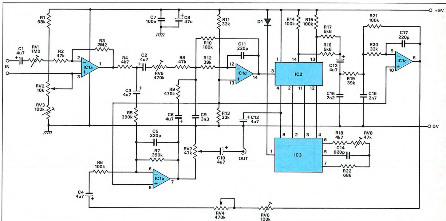
**Figura 2. Schema elettrico del Fuzz-Eco.**
