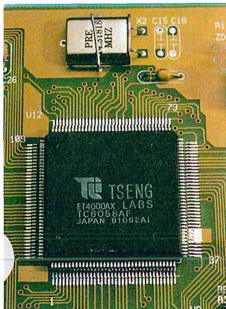
Un'interfaccia video è particolarmente valida se dotata di un convertitore digitale/analogico del segnale, meglio se di buona marca, come TsengLabs (foto a); non devono mancare i quarzi che generano il segnale di sincronismo per lo schermo (foto b) e nemmeno i dip-switch di settaggio come quello che definisce il modo di funzionamento monocromatico/colore.
