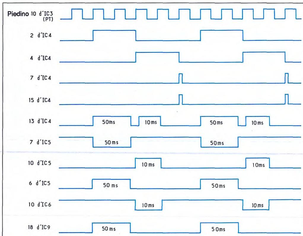
Figura 6. Cronodiagrammi di funzionamento rilevati nei punti strategici del circuito.
