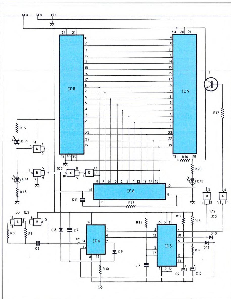
Figura 5. Schema di principio del duplicatore di EPROM 2716.
