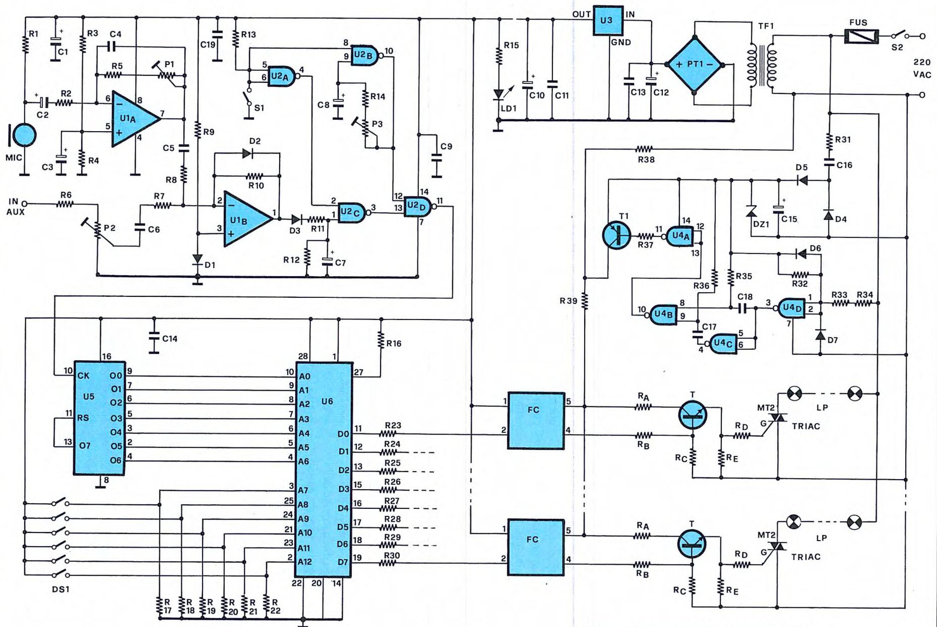
Figura 1. Schema elettrico dell'EPROM light.
