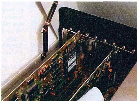
una palette di 256.000. Il connettore d'uscita di una scheda VGA è dunque analogico, e presenta 15 pin (a differenza dei 9 del digitale): è veramente universale perché permette il collegamento di qualsiasi monitor, o soltanto analogico (come i PS/2 o simili) oppure multifrequenza con doppio ingresso digitale/analogico (mediante apposito adattatore 9/15 pin).
