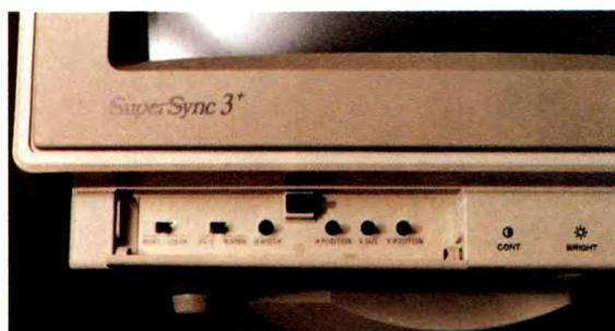
**Box di controllo.** I monitor multisincronismo o comunque più sofisticati presentano un box al quale si accede tramite sportellino apribile e richiudibile (5a); qui si trovano numerosi dispositivi di taratura e controllo dell'immagine nonché i commutatori di funzione (5b).
