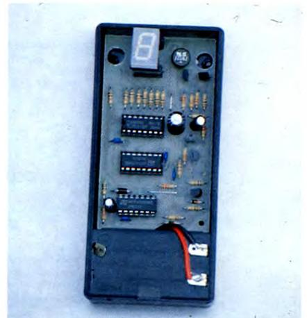
ria, vengono inviati al latch/decoder U2. Tra una cifra e l'altra, ovvero al termine dei primi tre impulsi, il pin 4 di U3c va a zero per un brevissimo istante attivando il pin di latch di U2. Il numero tre viene così memorizzato dal 4511 e visualizzato dal display. Subito dopo un breve impulso positivo viene applicato al pin *preset enable* di U1 il quale azzerà le sue uscite.
