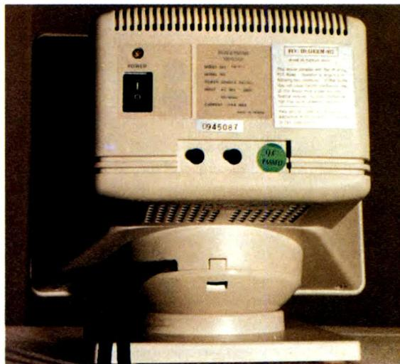
**Retro-monitor.** Si trovano sul retro genericamente i connettori d'ingresso video e di alimentazione a 220 V, ai quali vanno connessi i relativi spinotti (6a); apparecchi più semplici ed economici hanno i cavi direttamente innestati, dunque fissi e non staccabili dal cabinet (6b).
