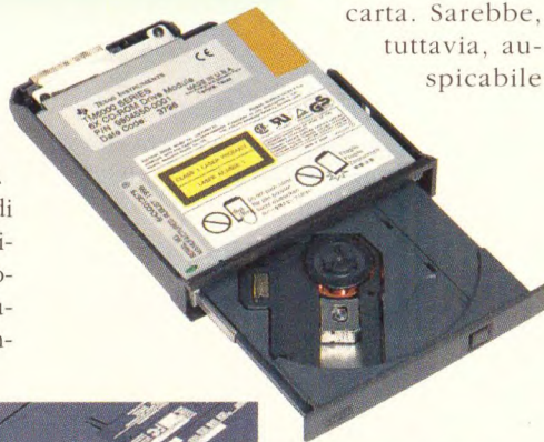
Il drive Cd-Rom è un 6x in grado di leggere anche i miniCd da 8 cm. Fra i formati supportati, PhotoCd e VideoCd (quest'ultimo richiede la scheda Zoom Video Port per visualizzare film Mpeg-1 full-screen).
