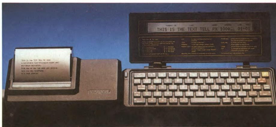
Stampante termica inserita a lato del PX 1000 con tastiera e display visibili, vista frontale. Il PX 1000 e la piccola stampante termica dedicata monodirezionale PXP 40. Notare la compattezza dell'insieme.
