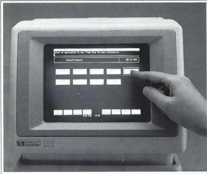
Fig. 3. Lo speciale tubo catodico che ospita il touchscreen può visualizzare fino a 24 righe di 80 caratteri ciascuna, più tre righe per il controllo tattile delle funzioni.
