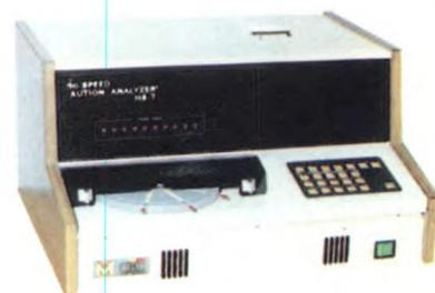
**Analizzatore per le urine** – Una cellula fotoelettrica permette di analizzare un campione di urine. Il procedimento automatico consente di rilevare il Ph, la presenza di glucosio, proteine, emoglobina, corpi chetonici ecc.
