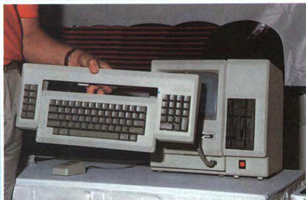
Alla tastiera del Mac vanno aggiunti un tastierino numerico ed i tasti di funzione, caratteristici del PC IBM.
