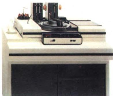
**Analizzatore M90** – L'analisi automatica computerizzata è possibile oggi con l'Analizzatore M90 che consente la cernita di campioni tarati anche in microquantità. I test sono programmabili in tutti i parametri richiesti: temporizzazione, prove cinetiche, reazioni differenziali, analisi colorimetriche, ecc.
