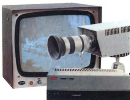
**Videolento** – Un sistema di trasmissione dati a distanza in modo bidirezionale è il videolento. Esso è composto di una telecamera, un monitor e un modem e permette la trasmissione di bioimmagini quali scintigrafie, tomografie, radiografie, T.A.C., flebogrammi, coronarografie, ecc.
