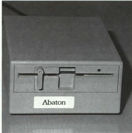
*Parecchi produttori indipendenti, stanno già producendo disk drive, a doppia faccia (800K di capacità), compatibili con i dischetti già esistenti; questo è della Abaton.*
