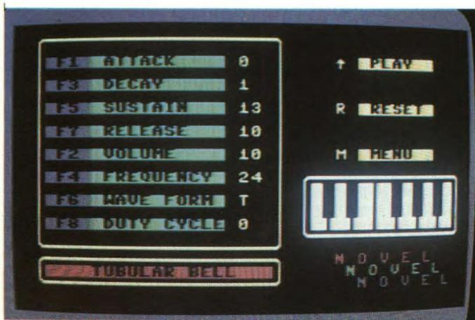
**Mono 64 - Il pannello dei comandi.** Notiamo nella parte alta dello schermo i sei riquadri comprendenti i diversi parametri modificabili relativi ad ogni singolo strumento preimpostato.
