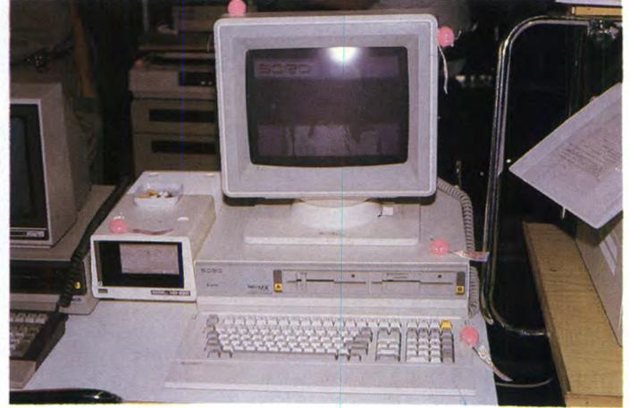
*Anche questo mostro di potenza della SORD, lo M68MX, utilizza il sistema operativo CPM. Caratteristiche salienti: processore Motorola 68000 a 10 MHz, ram interna espandibile a 3,5 Mbyte, ram disk, Linguaggi soliti: Basic, Fortran, Pascal, C, Cobol, Assembler 68000. Costo: 9,3 Megalire, neanche tante, se si pensa al fatto di poter disporre della potenza di un mainframe su di un aggeggio che trova posto su di una scrivania.*
