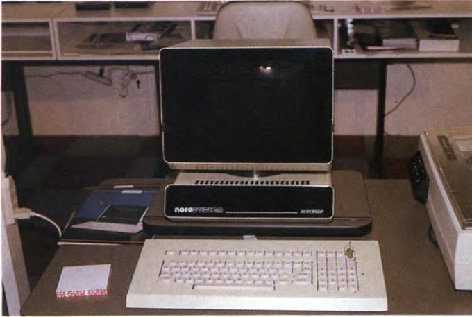
*Il SERIECINQUE della NORD SYSTEM: una originale soluzione per le multiutENZE in rete. Sistema operativo CPM compatibile. Gli utenti condividono comunicando attraverso una interfaccia seriale veloce RS-432 (quasi 500 Kbaud). Ogni utente può disporre di hard disk fino ad una capacità di 80 mega. La rete locale distribuita è senza dubbio una soluzione molto più intelligente del far condividere un unico grande calcolatore a molti utenti.*
